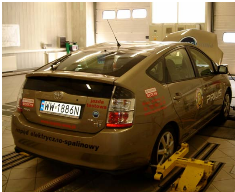
Rys. 2. Samochód Prius II z napędem hybrydowym na hamowni podwoziowej Fig. 2. Prius II with hybrid powertrain on chassis dynamometer
